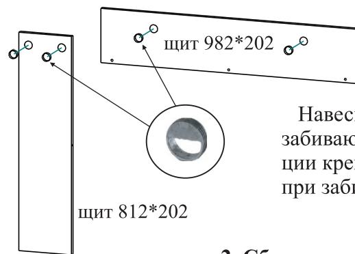
Навесы для шкафов нерегулируемые забиваются в щиты. Во избежании деформации крепежа, рекомендуется использовать при забивании жёсткую твёрдую прокладку.
