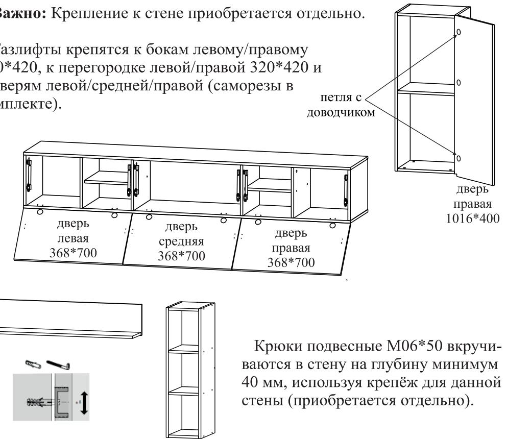
Крюки подвесные М06\*50 вкручиваются в стену на глубину минимум 40 мм, используя крепёж для данной стены (приобретается отдельно).
